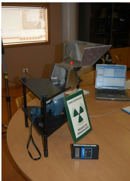
Figura 2: Fotografía del espectrómetro de fluorescencia de rayos X, dotado de un soporte para el posicionamiento de las muestras
